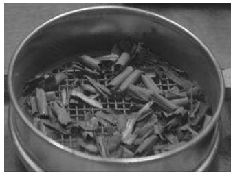
Tronçon de gaine Zircaloy (COQUE)
