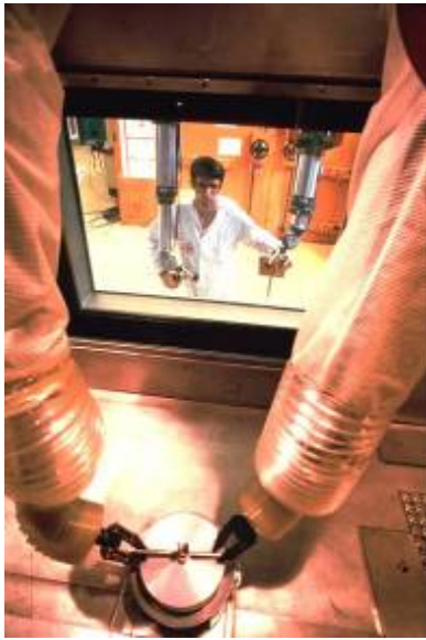
"Télé-manipulation" En cellule chaude
