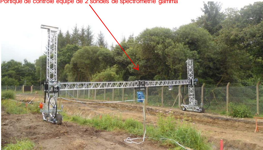
Portique de contrôle équipé de 2 sondes de spectrométrie gamma
